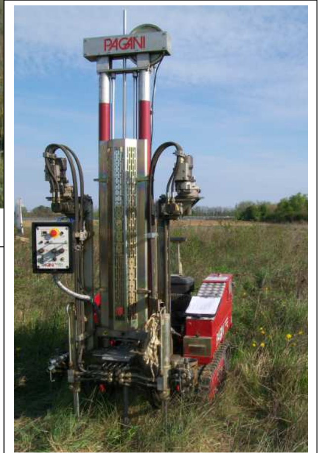
PENETROMETRO PAGANI TG 63 -200 PROVA DPSH N. 7
