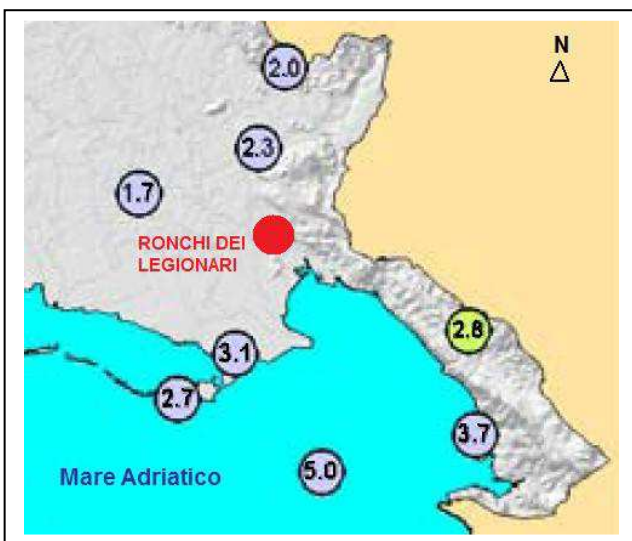
Velocità e frequenza nei diversi ottanti, dei venti che soffiano a 10 m di altezza. (Osmer, Arpa 1999 – 2008).
