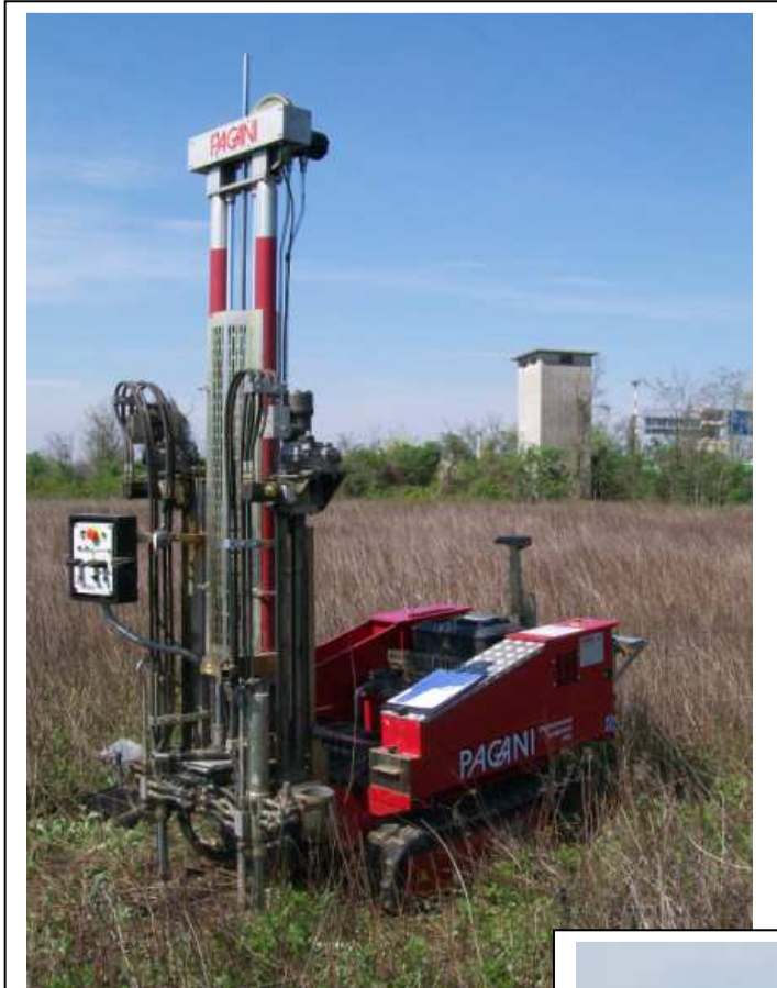
PENETROMETRO PAGANI TG 63 -200 PROVA DPSH N. 2
