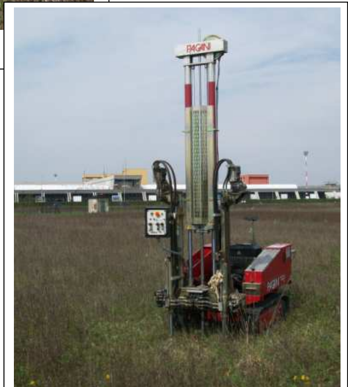
PENETROMETRO PAGANI TG 63 -200 PROVA DPSH N. 4
