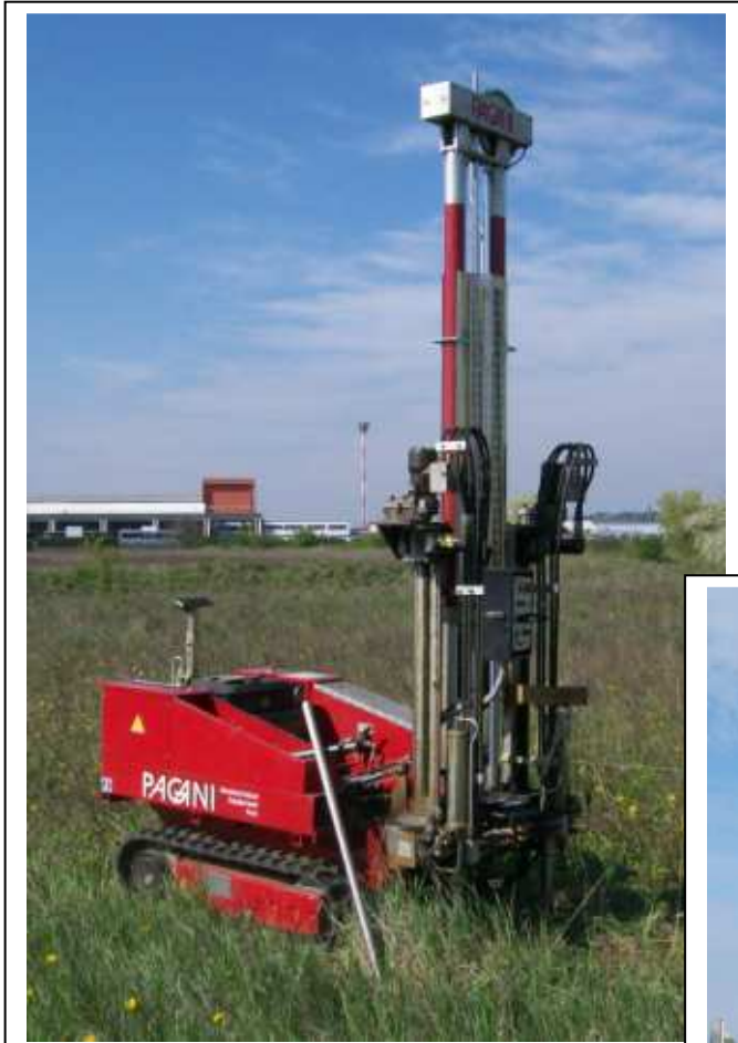
PENETROMETRO PAGANI TG 63 -200 PROVA DPSH N. 6
