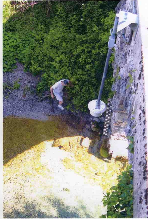
SENSORE A ULTRASUONI CON ASTA IDROMETRICA DI RIFERIMENTO
