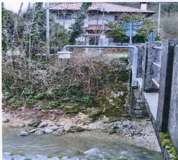
Figura 144 – Stazioni idrometriche automatiche con teletrasmissione dei dati
