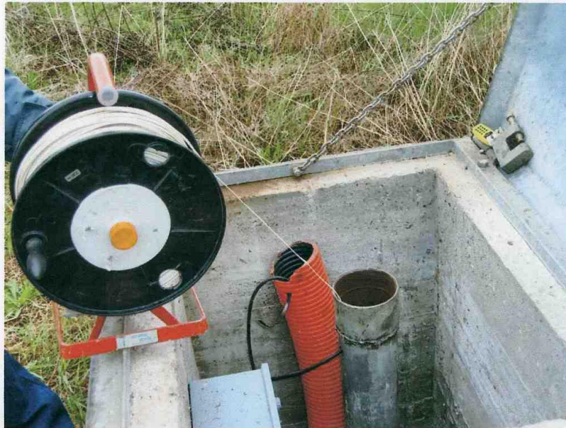
LAYOUT DI POZZO CON INSERITO SENSORE PIEZORESISTIVO E CAVO DI COMPENSAZIONE BAROMETRICA
