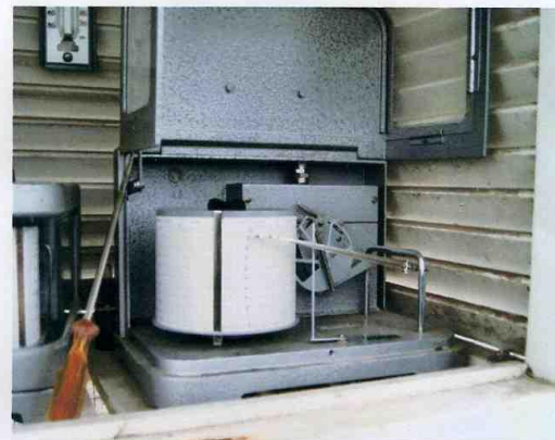
DETTAGLIO PLUVIOGRAFO SIAP
