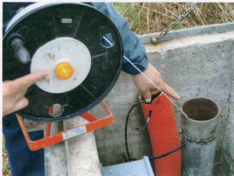
MISURA FREATIMETRICA IN POZZO CON SCANDAGLIO
