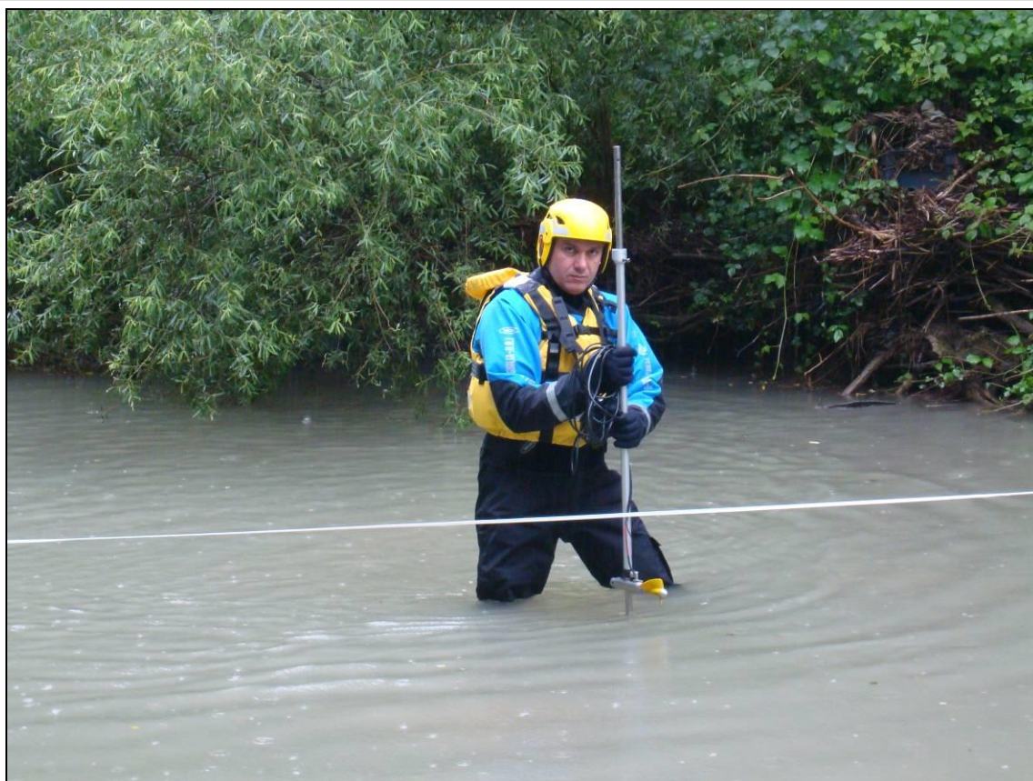
Figura 145 - Operatore U.O.I. durante una misura di portata al guado con correntometri a elica
