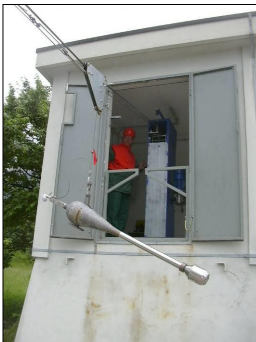
Figura 124 - Stazione di misura della portata di Pioverno dotata di impianto di teleferica
