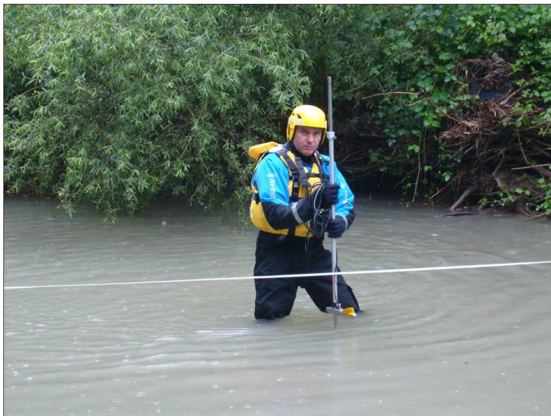
Figura 146 - Operatore U.O.I. durante una misura di portata al guado con correntometri a elica
