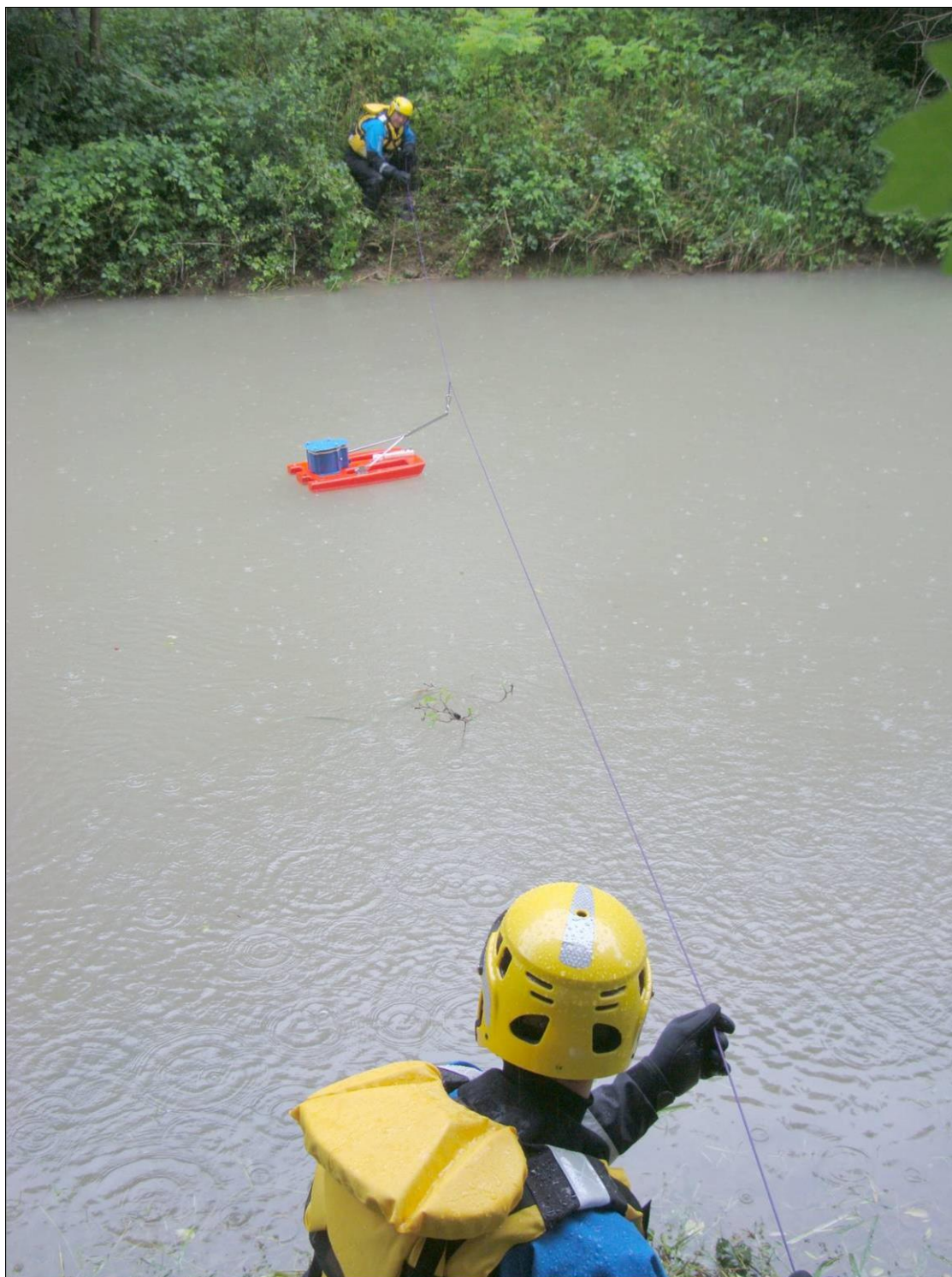
Figura 148 - misura di portata con l'utilizzo di ADCP montato su natante
