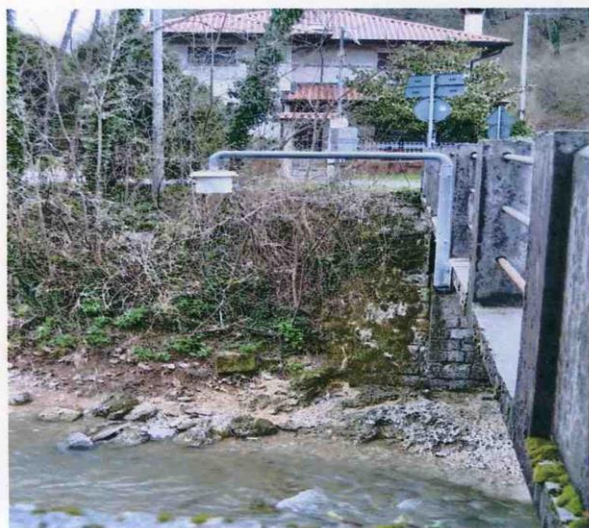
Figura 145 – Stazioni idrometriche automatiche con teletrasmissione dei dati
