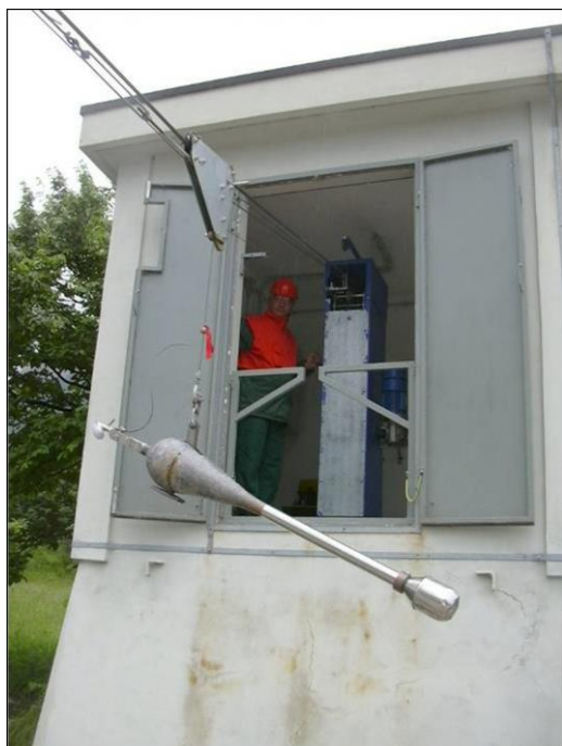
Figura 147 - Stazione di misura della portata di Pioverno dotata di impianto di teleferica
