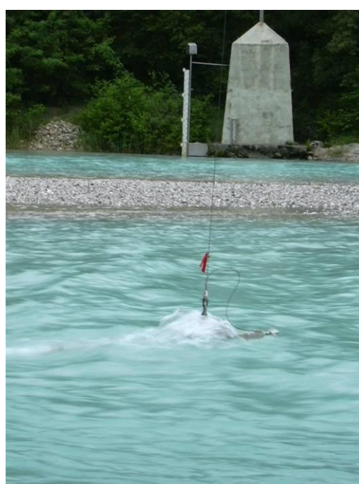
Figura 147 - Stazione di misura della portata di Pioverno dotata di impianto di teleferica
