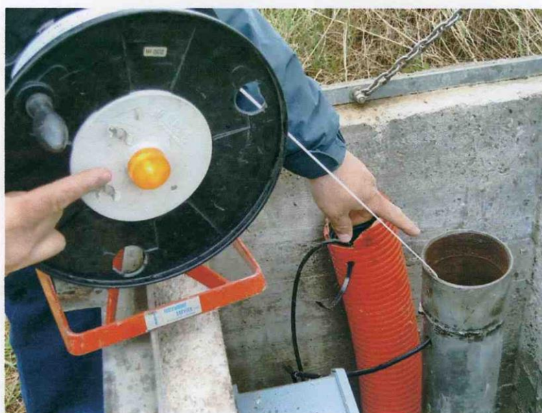
MISURA FREATIMETRICA IN POZZO CON SCANDAGLIO
