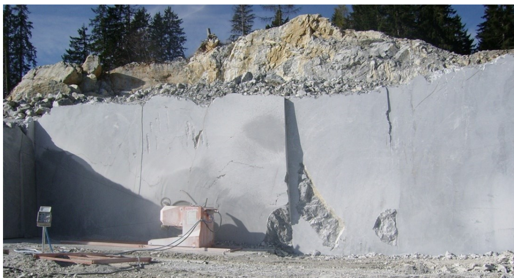
Coltivazione con filo diamantato nella cava del marmo "Grigio Naguscel Carnico" (Cava Clap di Naguscel, UD)
